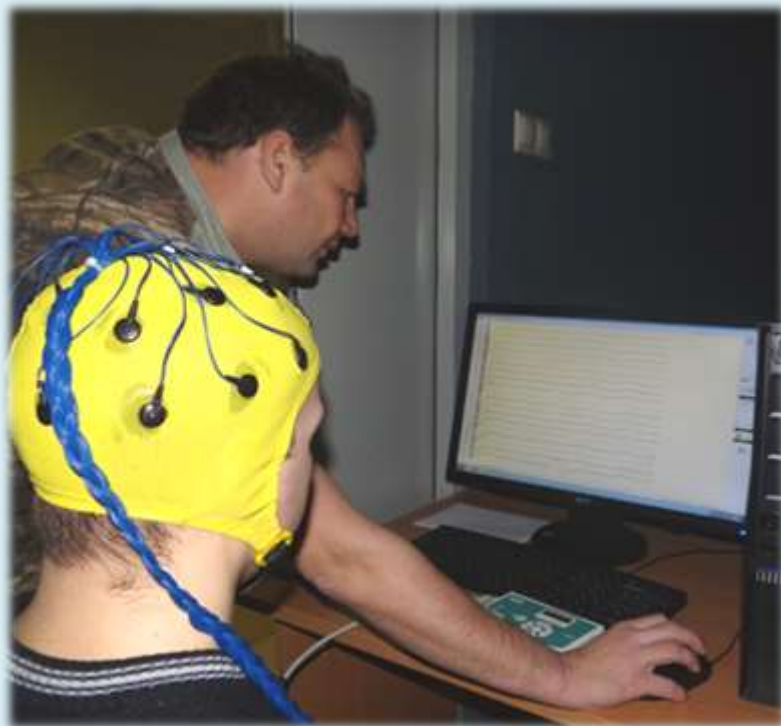
Настройка и установка энцефалографа в кабине машиниста
