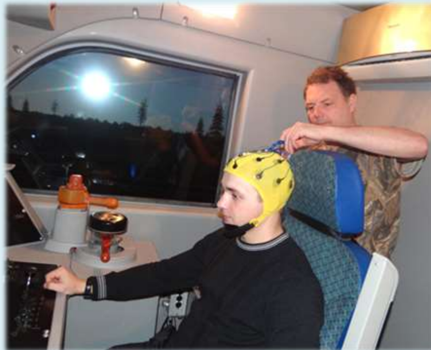
Настройка и установка энцефалографа в кабине машиниста
